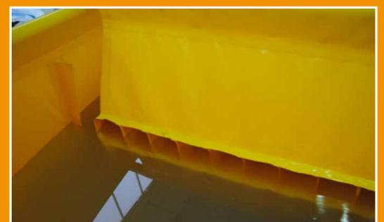
Tanque de Decantación en dos módulos formados por cámaras
