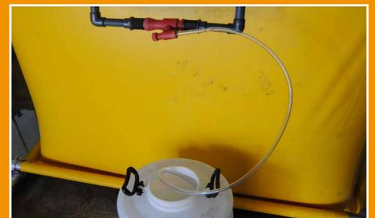
Adición del coagulante por sistema venturi a través de la succión de la bomba
